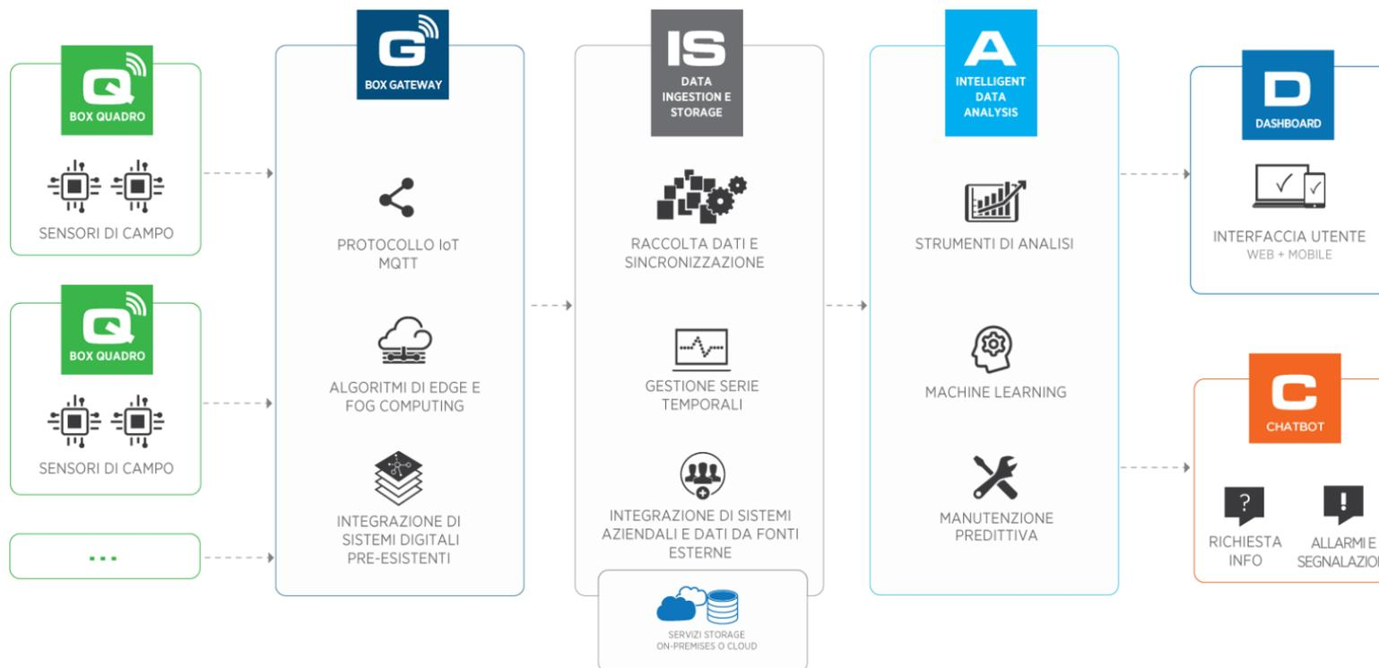
È costituito dai seguenti elementi: dispositivo "di campo" che opera secondo IIoT (OPC-UA) per interfacciamento con PLC, MES, sistemi informativi, CRM, BI; multimetro/power-meter industriale; sistema notifiche ChatBot per interrogazione e alerting; Dashboard KPI.
